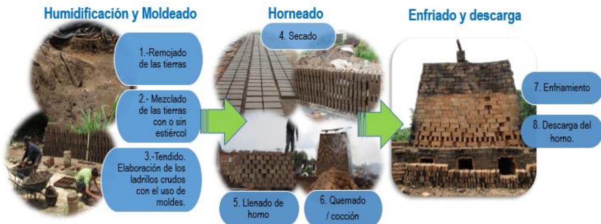
Figura 10. Proceso de producción de ladrillo artesanal
