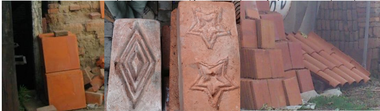
Figura 17. Ejemplos de productos artesanales complementarios al ladrillo: loseta de Tlaxcala a la izquierda, al centro ladrillos ornamentados de Metepec (Estado de México) y a la derecha petatillo y tejas de El Arenal (Jalisco)
