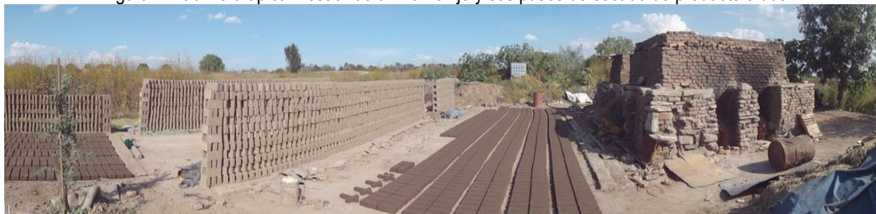
Figura 1. Ladrillera típica mostrando un horno fijo y sus patios de secado de producto crudo
