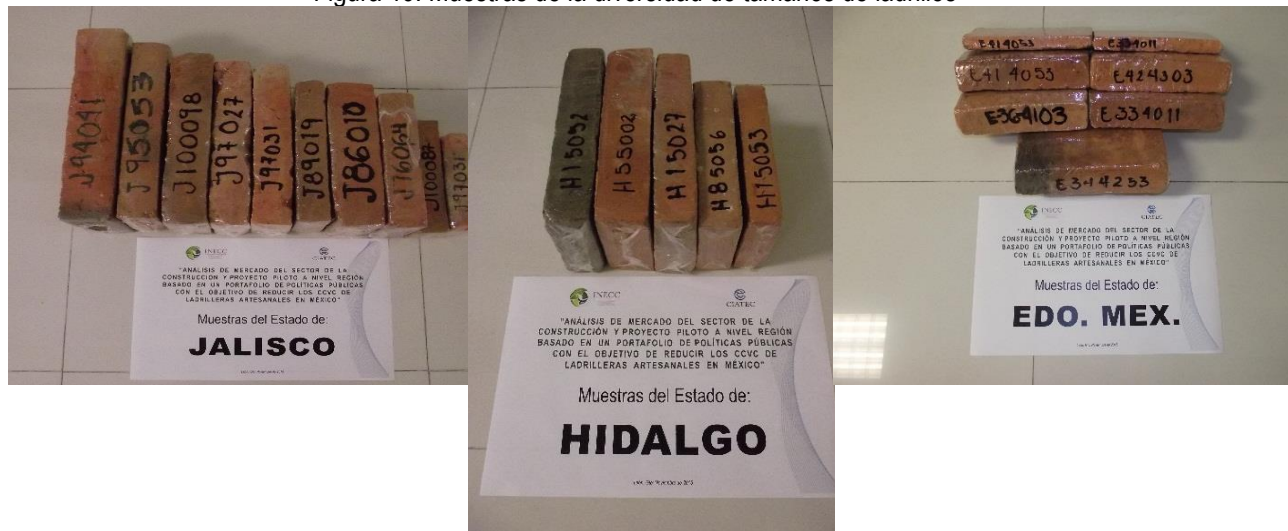
Figura 19. Muestras de la diversidad de tamaños de ladrillos
