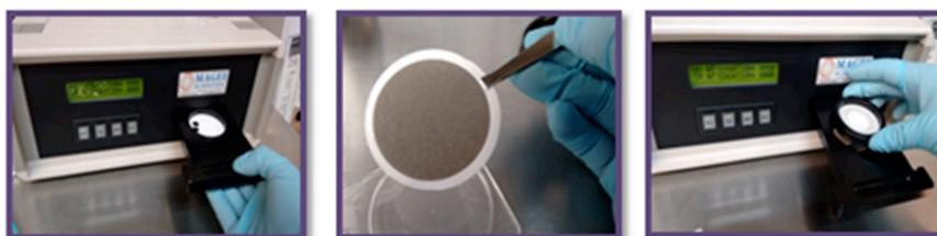
**Figura 3. Análisis de carbono negro en las partículas suspendidas mediante transmisómetro por atenuación de luz infrarroja**
