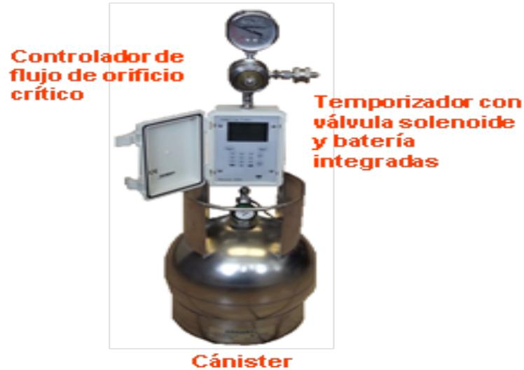
**Figura 6. Adaptación de controlador de flujo de orificio crítico y temporizador para realizar muestreos integrados y programados.**
