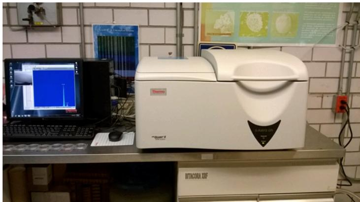
**Figura 4. Análisis de composición elemental por Fluorescencia de Rayos X por energía dispersiva**
