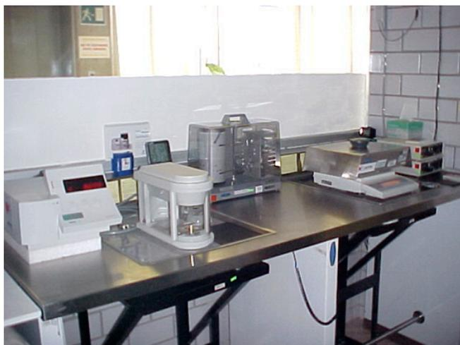
**Figura 2. Acondicionamiento y pesaje de filtros pre y post-muestreo**
