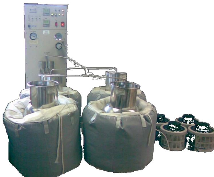
**Figura 5. Cánisters SUMMA de acero inoxidable de COVs. Sistema de limpieza de los cánisters mediante ciclos de vacío y purga con nitrógeno y calentamiento con mantillas.**
