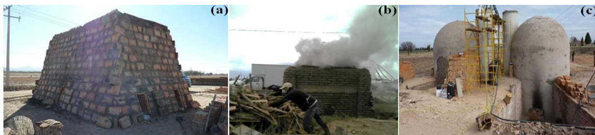
Figura 1. Hornos ladrilleros (a) tradicional de campana, (b) tradicional fijo, (c) MK2. Fuente: archivos del INECC.
