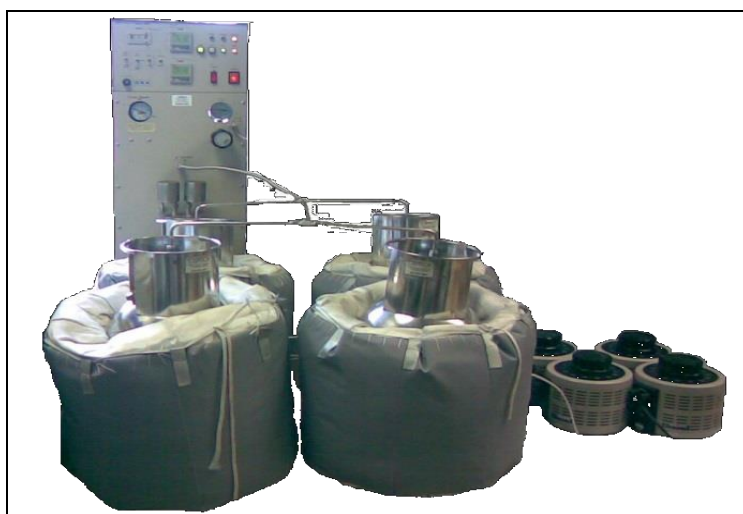
Figura 5. Cánisters SUMMA de acero inoxidable de COVs. Sistema de limpieza de los cánisters mediante ciclos de vacío y purga con nitrógeno y calentamiento con mantillas.
