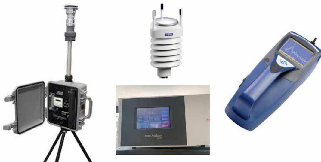
Figura 2.68. Equipos empleados durante la campaña de mediciones. De izq. a der.: muestreador portátil de aire, de bajo volumen, analizador automático de ozono con sensor meteorológico acoplado y monitor portátil de  $PM_{2.5}$ .
