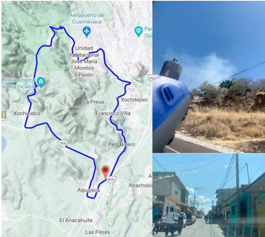
Ejemplo de los recorridos realizados, portando monitor portátil de PM2.5 y GPS, para determinar la exposición personal a nivel de banqueta.
