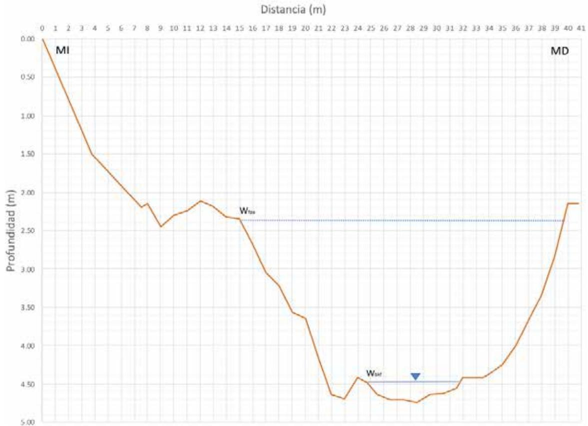
Figura 2.24. Sección en la estación río Cuentepec después de confluencia. Fuente: Elaboración propia.
