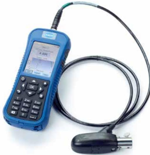
Figura 2.61. Medidor de flujo Hach FH950.
