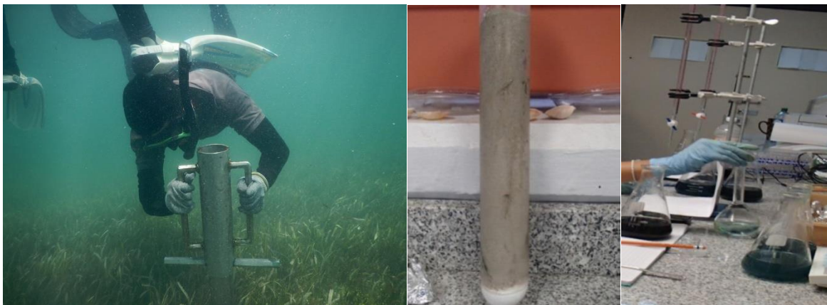
Figura 3. Método de colecta y análisis de sedimentos para porcentaje de carbono y materia orgánica (fotos tomadas por el laboratorio de pastos marinos, 2015).
