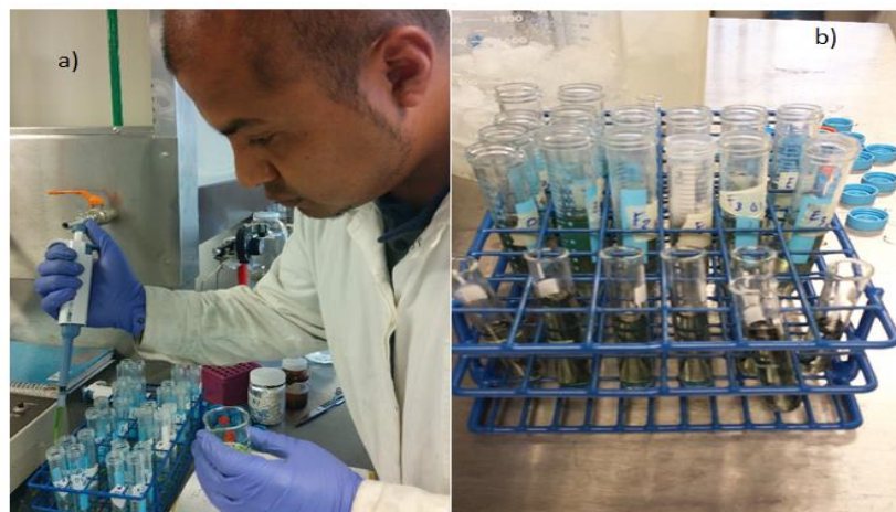
Figura 7. Cuantificación de fenoles. a) Adición de solución de fenilfenol; b) Muestras listas para evaluación en espectrofotómetro (fotos tomadas por Isidro Arellano, 2015).
