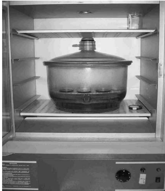
Figura 5.6 Cámara de desecación con cajas Petri que contienen nematodos para infiltración en glicerina.
