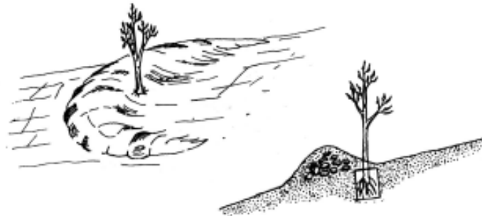
Fig. III.2 Cepa de microcuena: a) vista superior; y b) corte lateral.
