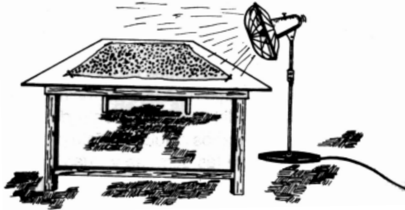
Fig. II.6 Secado de semillas con flujo continuo de aire.
